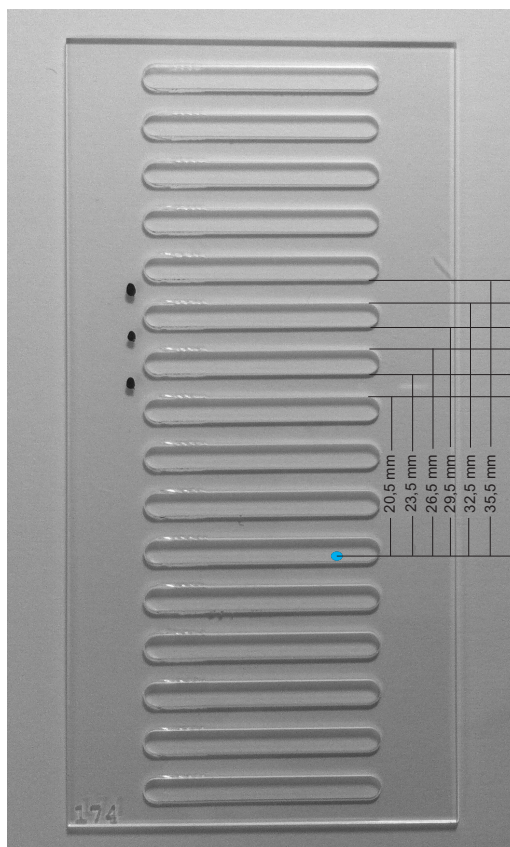
Abbildung 4.1: Fotografie eines speziell für die Kalibrierung des MCP-Detektors hergestellten CR-39-Plättchens. Hier sind die drei für die Kalibration genutzten Stege (markiert durch schwarze Punkte) sowie die entsprechenden Abstände zum Nullpunkt (blauer Punkt) dargestellt.
