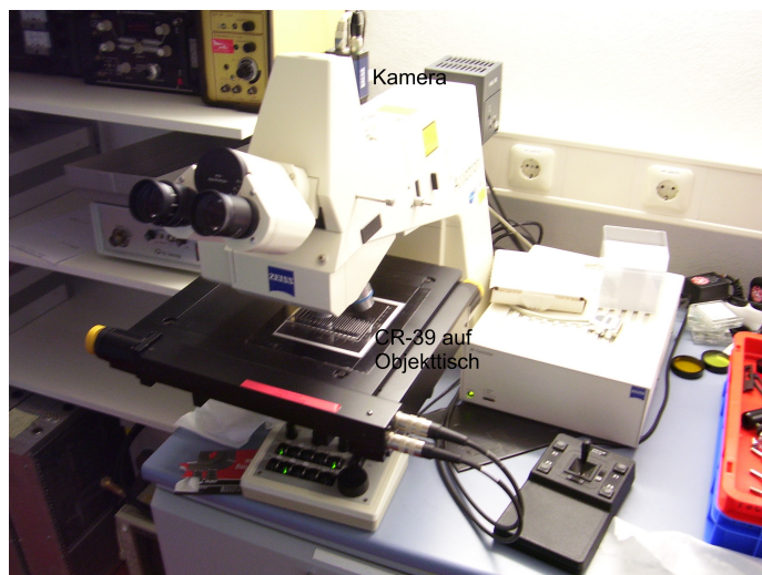
Abbildung 3.9: Hier ist das Axiotron II Lichtmikroskop zu sehen. Der Objektisch ist horizontal frei bewegbar und wird vom Programm SAMAICA während eines Scanvorgangs gesteuert. Auf dem Objektisch befindet sich ein CR-39-Plättchen zur MCP-Kalibrierung. Die Kamera ist mit dem Messrechner verbunden und das CR-39-Plättchen kann mit SAMAICA betrachtet werden..
