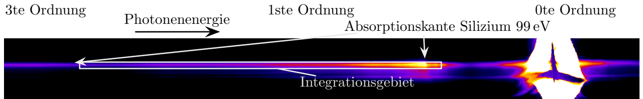
Abbildung 4.4: Rohdatenbild der CCD-Kamera bei SD-XCT auf reiner Siliziumoberfläche: Das Bild wurde bereits so gedreht, dass die dispersive Ebene in horizontaler Richtung liegt. Die Belichtungszeit betrug 60 s. Das Gebiet in dem alle Counts aufaddiert wurden, ist mit einem weißen Rechteck markiert. Der Bereich wurde so gewählt, dass der Einfluss der dritten Beugungsordnung vernachlässigt werden kann. Der Abstandes jeder vertikalen Pixelreihe zur Position der nullten Beugungsordnung kann mit Hilfe der Spektrometerekalibrierung einer Photonenenergie zugeordnet werden. Das Spektrum ist nicht moduliert. Die Absorptionskante von Silizium bei 99 eV ist deutlich zu erkennen.
