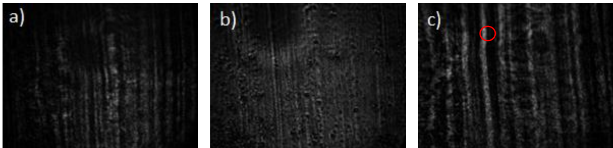
Abb. 4.12 a) – c): Ausschnitte aus dem Tiefenscan einer Aluminiumfolie, dargestellt sind in Bild a) -100 \mu\text{m} vor der geschätzten Fokusslage, Bild b) geschätzte Fokusslage bei 25 \mu\text{m} in Diagramm, Bild c) 100 \mu\text{m} hinter der geschätzten Fokusslage
