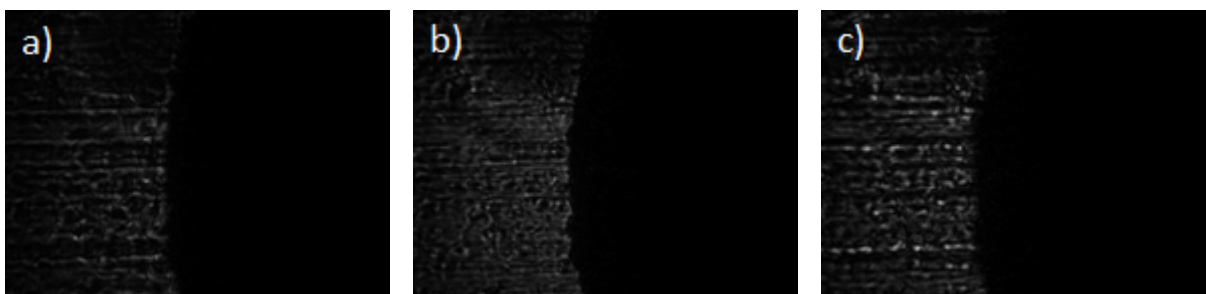
Abb. 4.18 a) – c): Ausschnitte aus dem Tiefenscan des Lochs im Subhalter, dargestellt sind in Bild a) -20 \mu\text{m} vor der geschätzten Fokusslage, Bild b) geschätzte Fokusslage bei 20 \mu\text{m} im Diagramm, Bild c) 20 \mu\text{m} hinter geschätzten Fokusslage
