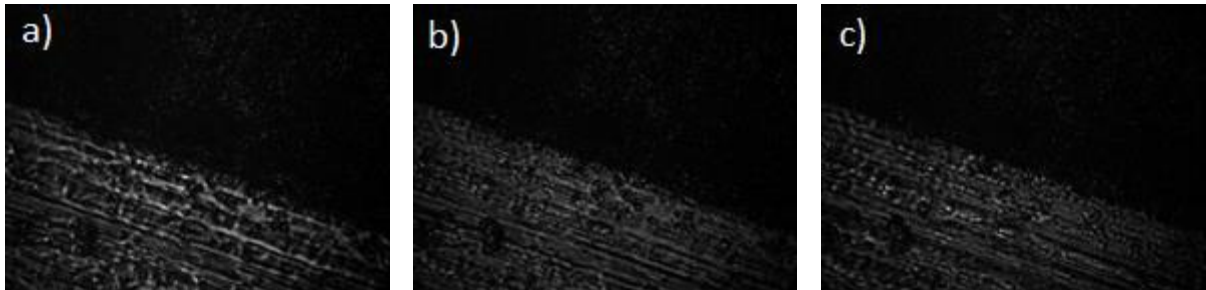
Abb. 4.19 a) – c): Ausschnitte aus dem Tiefenscan des Randes zur Einsenkung auf dem Subhalter, dargestellt sind in Bild a) -10\ \mu\text{m} vor der geschätzten Fokusslage, Bild b) angenommene Fokusslage (Position 5\ \mu\text{m} ), Bild c) 10\ \mu\text{m} hinter der geschätzten Fokusslage (Position 15\ \mu\text{m} )
